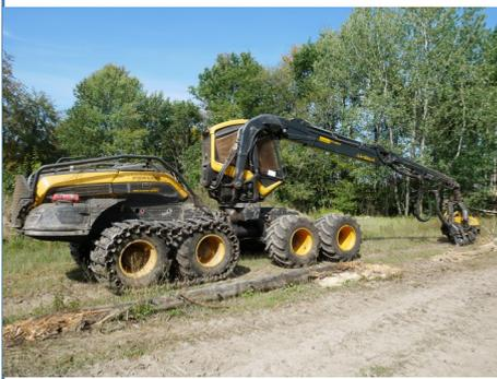
*Der Harvester braucht nur wenige Minuten, um einen Baum zu packen, abzusägen, zu entasten und auf genaue Länge gesägt abzulegen. Der Forwarder sammelt die Stämme im Gelände ein und stapelt sie nahe der Wege. Der Abtransport erfolgt später in großen Übersee-Containern.*
